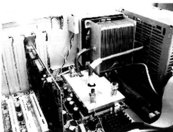
Figura 1- Cooler experimental da HP que utiliza o efeito termossifão
